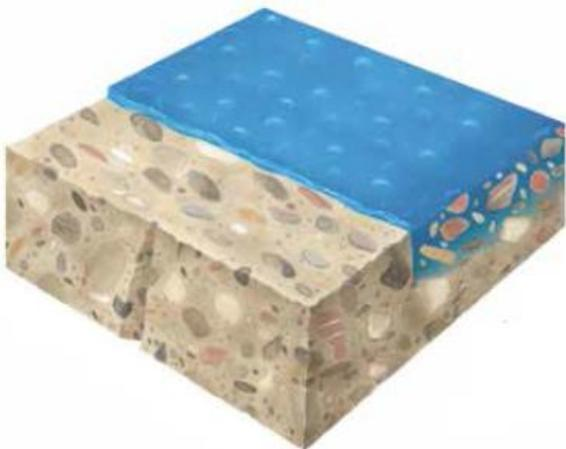
INDUFLOOR®-IB 프라이머는 슬라브 표면으로 침투하여 표면 하부에 차단막을 형성하고 지속적으로 증가하는 수분, 염분 등의 접착 방해 물질로 안전하게 보호하여 준다 (습윤면 시공가능 프라이머)
